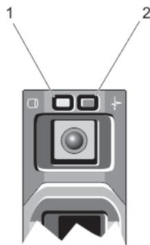
図 3. ハードディスクドライブインジケータ
